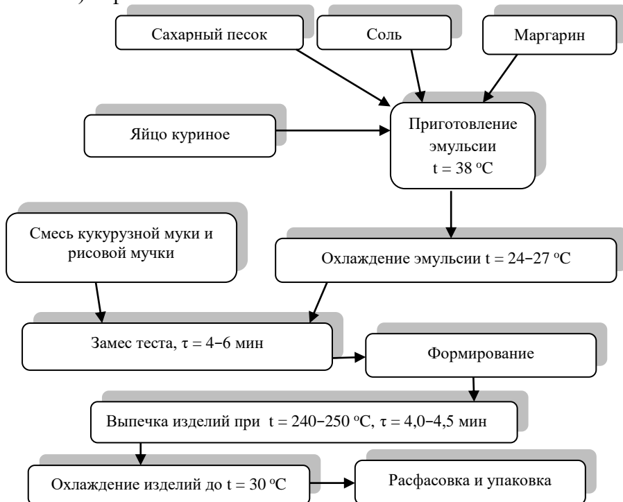
Рисунок 24 – Технологическая схема приготовления печенья
